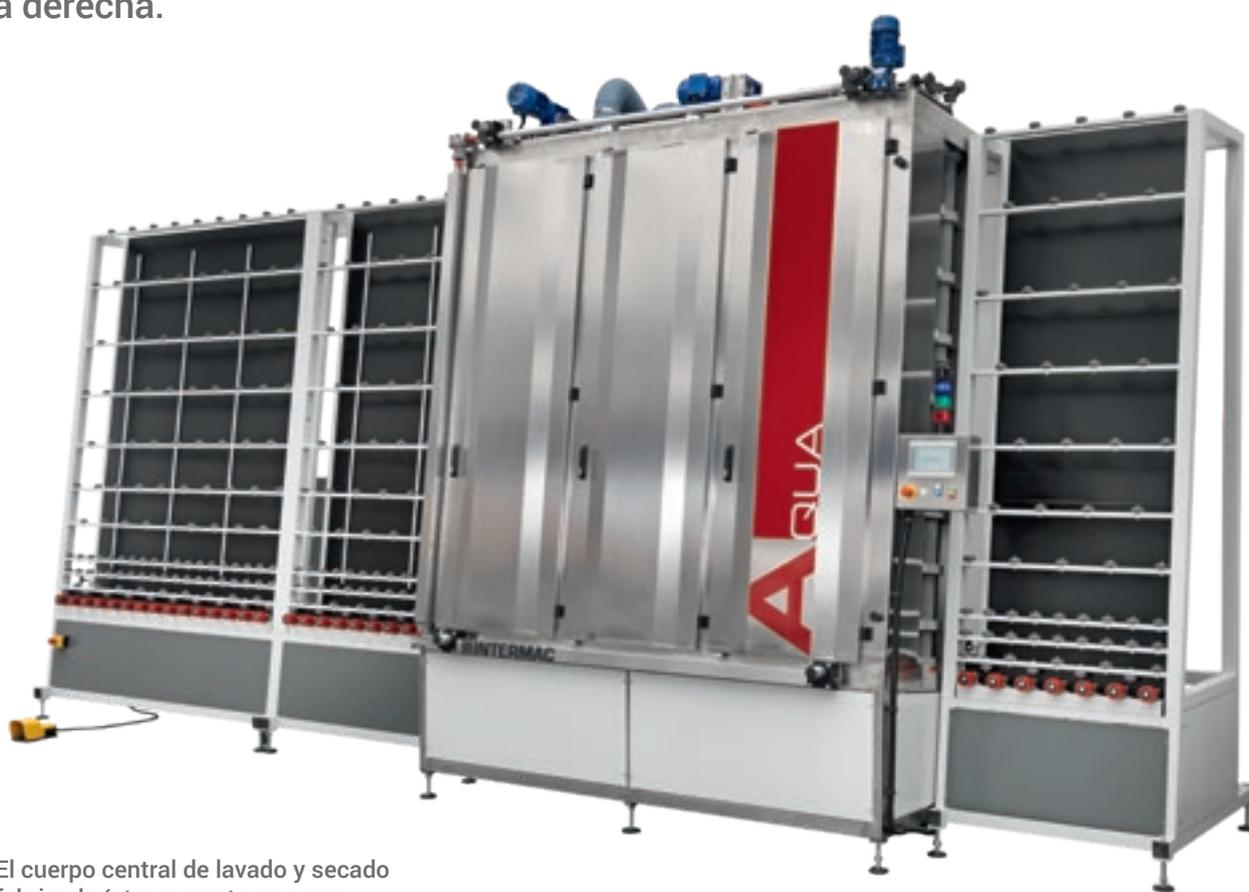
El cuerpo central de lavado y secado fabricado íntegramente en acero inoxidable garantiza seguridad y resistencia a largo plazo.
